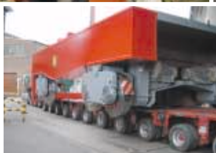
Stahltransportwagen 11 x 6 x 7,3 m; Tragkraft 420 t
