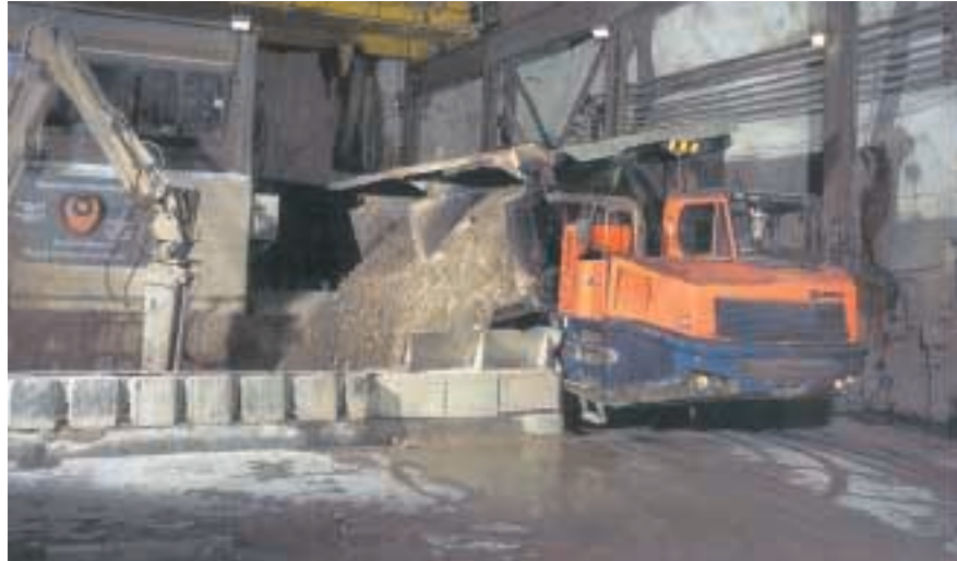
Ein 80 t-Tamrock Supra Seitenkipper entlädt seine Ladung innerhalb weniger Sekunden in den Untertagebrecher
