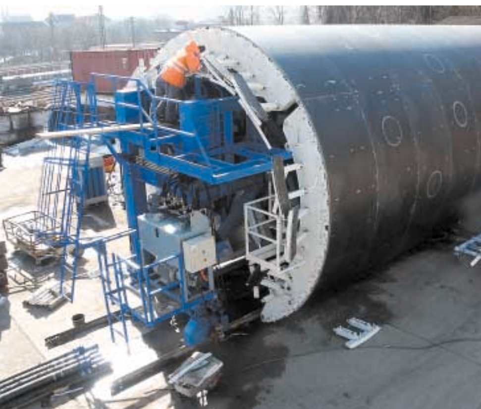
Komplettansicht des vormontierten Tunnelschalwagens
