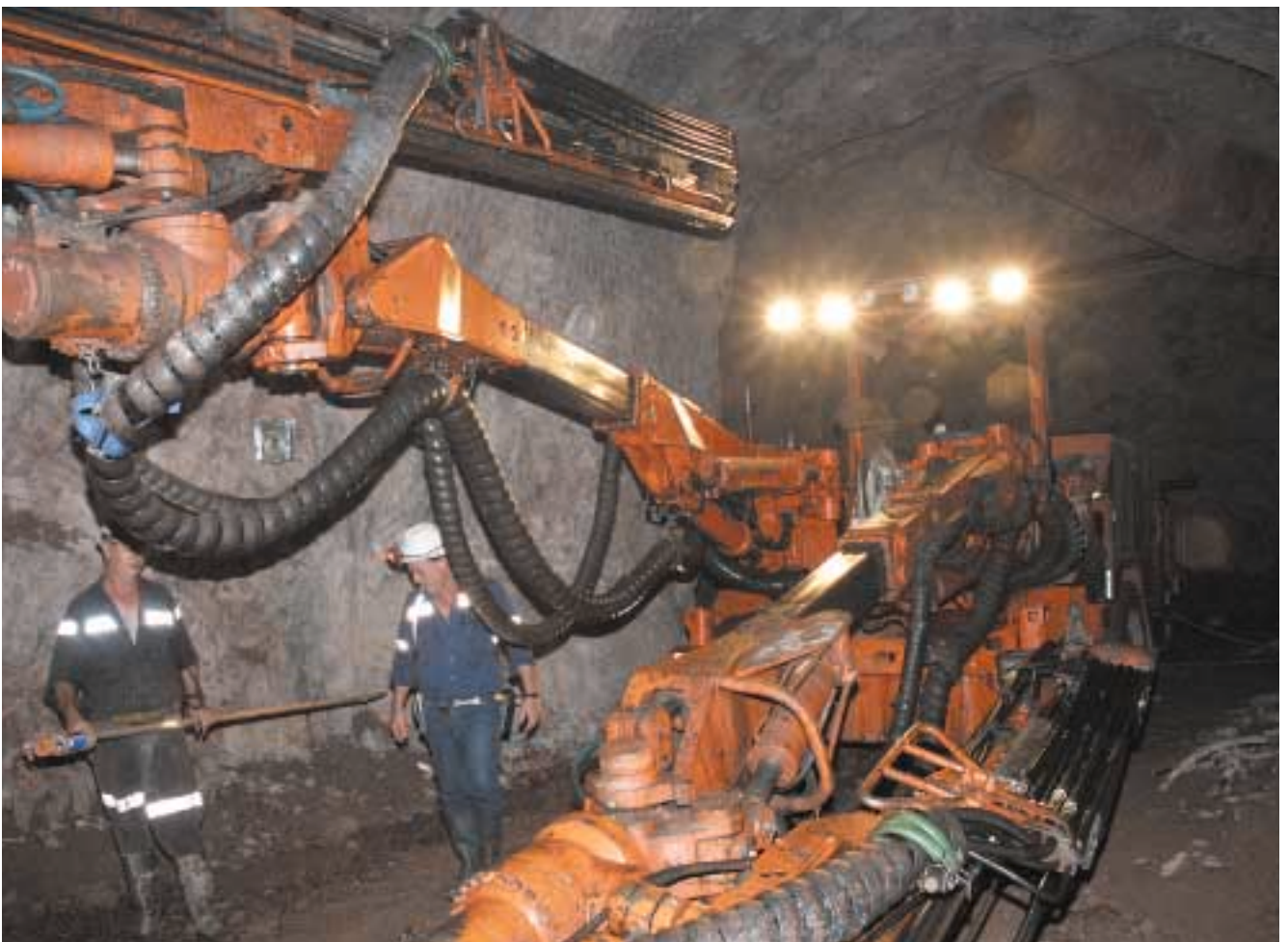
Zweiarmiger Bohrwagen (Jumbo) im Einsatz
