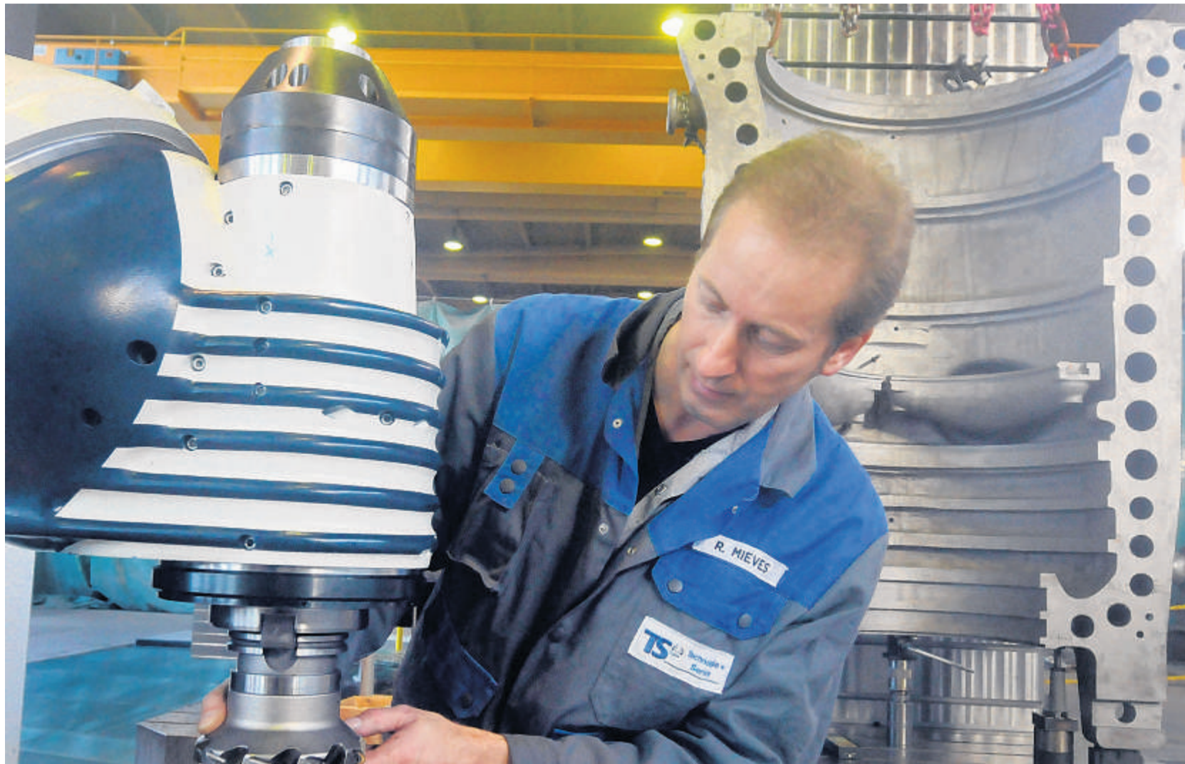
Hier setzt Zerspanungstechniker Ralf Mieves einen neuen Fräskopf an die Maschine, die so vieles möglich machen soll.
